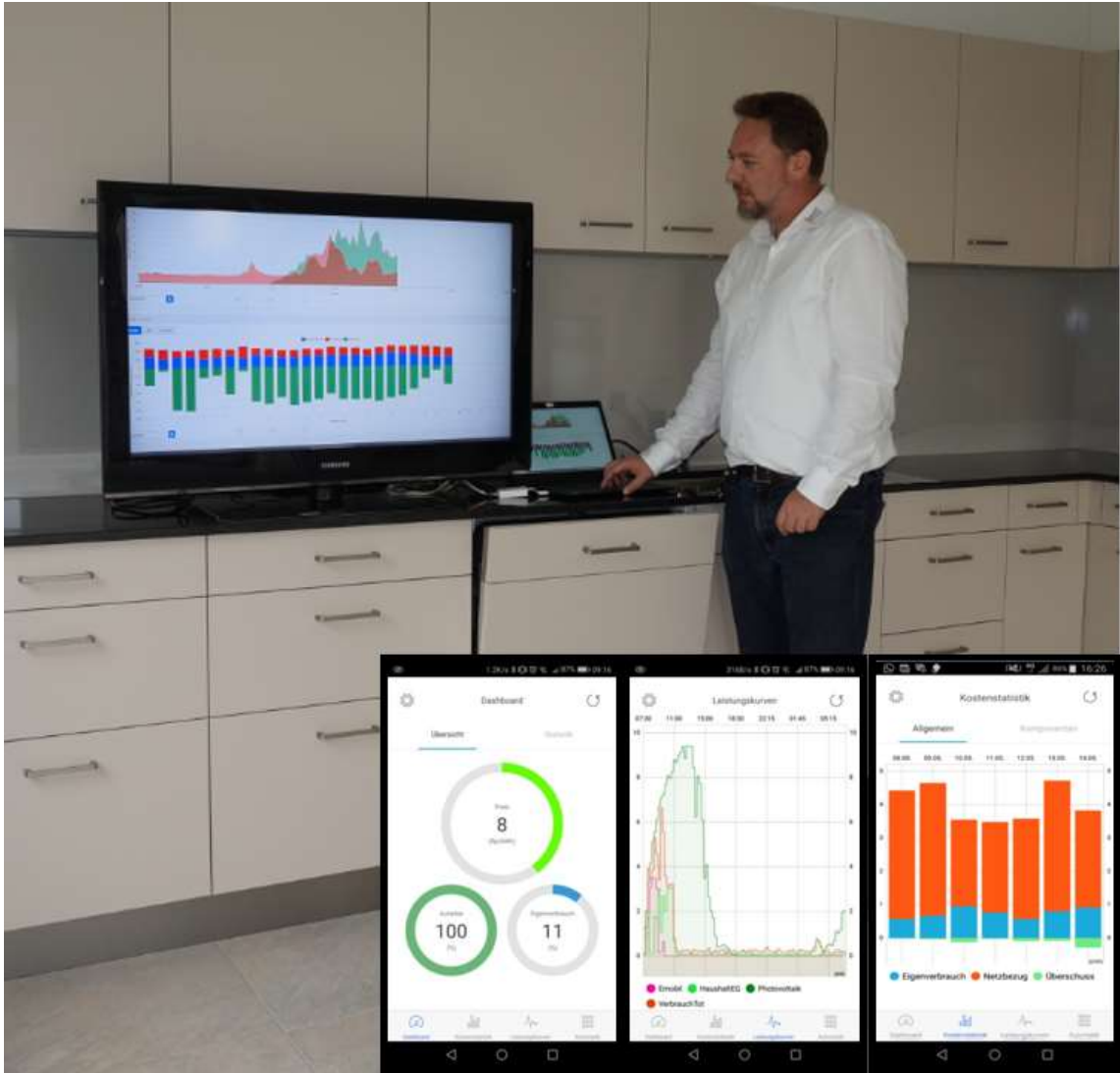
Abbildung 8: Visualisierung für Bewohner und Betreiber. Grosses Bild: Webportal auf PC mit Energiestatistik. Kleine Bilder unten: Portal auf Smartphone mit aktuellem Strompreis, Autarkiegrad/Eigenverbrauchsgrad, Leistungsverläufe, Statistik (Quelle: Smart Energy Engineering)
